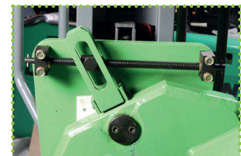
Dettaglio scorrimento forche su vite senza fine
