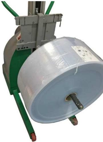
L'accessorio "forche regolabili" consente di utilizzare il carrello in modo analogo allo sperone, potendo essere utilizzato con una forca centrale ad esempio per la movimentazione di bobine.
