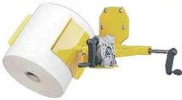
L'accessorio consente di movimentare bobine o fusti da 300 a 600mm di diametro. A differenza dello sperone o del rotobobine non impegna per la presa l'anima centrale ma agisce con una presa esterna a doppia pinza. In tal modo può essere utilizzato anche come girafusti.
