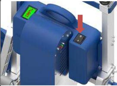
1. Premere l'interruttore di avvio del dispositivo. Il livello residuo della batteria è visualizzato sulla sinistra della cassa.
