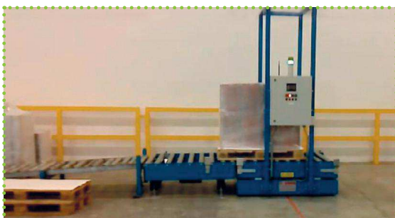
Navetta porta-pallet con rulliera, per trasporto a/da avvolgitore
