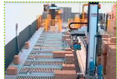
Pallettizzatore per presa multistadio a ventosa per 20 prelievi e 20 depositi
