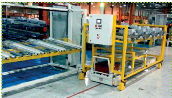
Navetta con sistema scambio automatico contenitori vuoti/pieni
