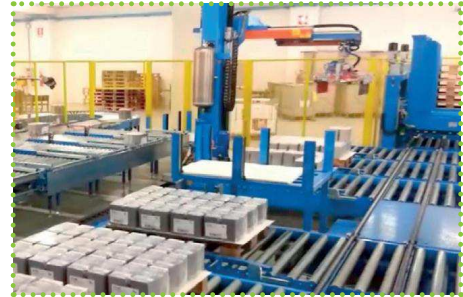
Robot cartesiano di pallettizzazione con 6 punti di prelievo e 6 di deposito
