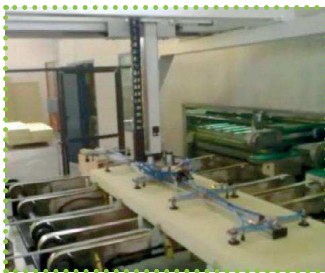
Pick&Place con presa a ventose per lastre
