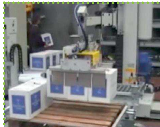
Pallettizzatore a presa multipla per scatole, con 2 punti di prelievo e 2 di deposito
